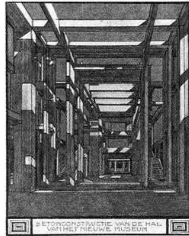
H.P. Berlage, La struttura ossatura in cemento armato della testata di ingresso come da disegno eseguito da Berlage durante la costruzione del Museo municipale all'Aia
